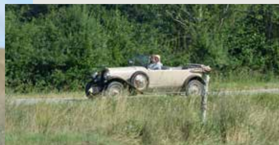
Norske Bjørn Skjærviks Mors har oprindelig kørt i England, hvilket antagelig forklarer den dens kaffe-med-fløde farveholdning. Motoren købte Mors hos Minerva, der benyttede dobbelte glidere i stedet for ventiler. Den går særdeles tyst og lægger en fin lysegråblå røgfane bag sig, når der gasses op. Den støvede grusvej skjulte det dog på en god del af turen.
