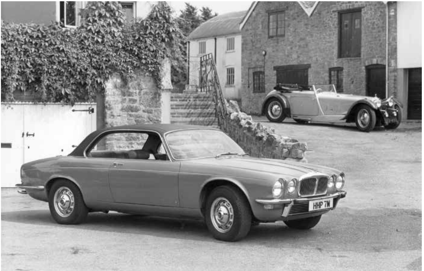
Den to-dørs Coupé, også kendt som XJC, fandtes kun i Series 2 og med både 6- og 12-cylindrede motorer. Her er det en 12-cylindret i Daimler-udgave. V12-modellerne fik hos Daimler navnet "Double Six", navnet lånt fra bilen i baggrunden – Daimler double Six 1931. Daimler kan skelnes fra Jaguar på kølgitteret med rillerne i overkanten. Fabrikfoto fra Paul Skilleter via Claus Frausing.
