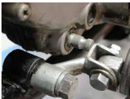
Bridgestone 350 motorcyklerne var så rigt udstyret, at man selv kunne vælge om man ville have gear og bremser siddende på højre eller venstre side.
