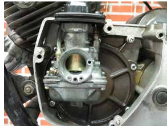
Her ses systemet med karburatoren monteret.
