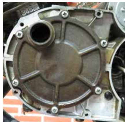
Et dæksel over drejeventilen tillader montering af karburator.
