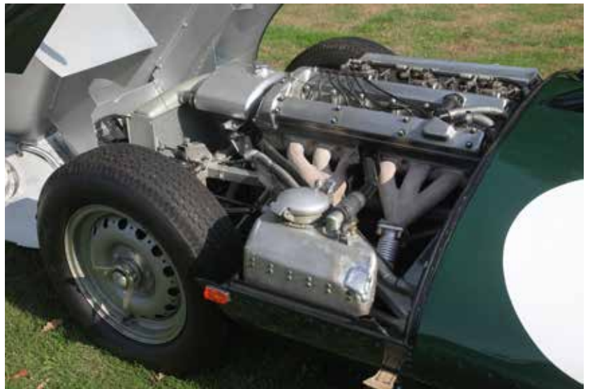
Den store motor har tørsumpsmøring og altså intet bundkar. Derved kan motoren ligge dybere i vognen, hvilket også bidrager til et lavere tyngdepunkt. På billedet ses olietanken bag forhjulet.
