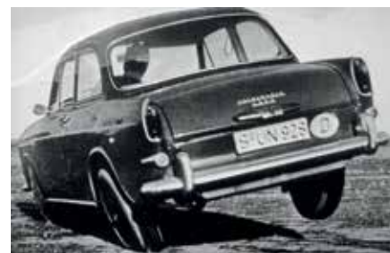
På dette foto fra en tysk demonstration ses tydeligt, at risikoen for væltning kan forstærkes af at fælgkanten hugger ned i vejen.
