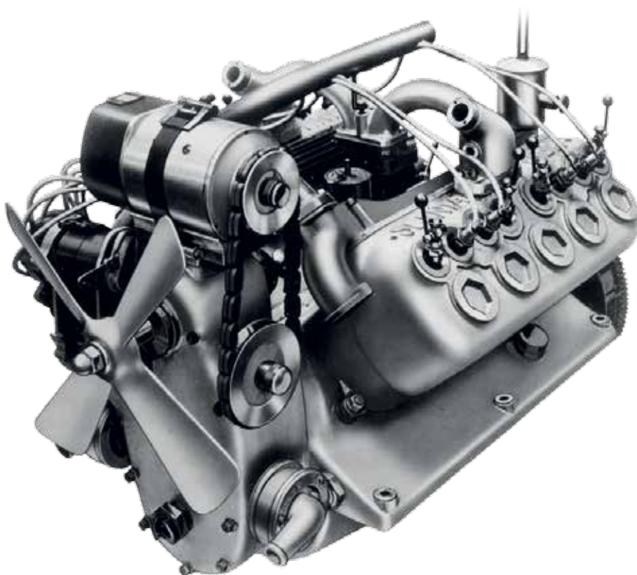
Den ottecylindrede V-motor konstrueret af dansk Scania-Vabis i 1916. I årene 1917-18 blev den bygget i en serie på 25 stk. Den havde et maksimalt omdrejningstal på 3.400 omdr./min. og ydede 50 hk ved 1.900 omdr.
