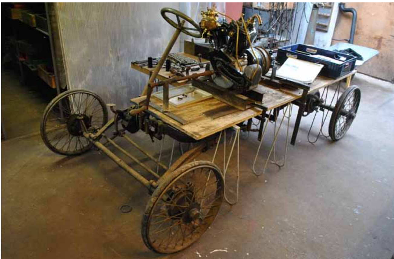
Den restaurerede Forward motor, anbragt på en plade liggende oven på den urestaurerede chassissamme
