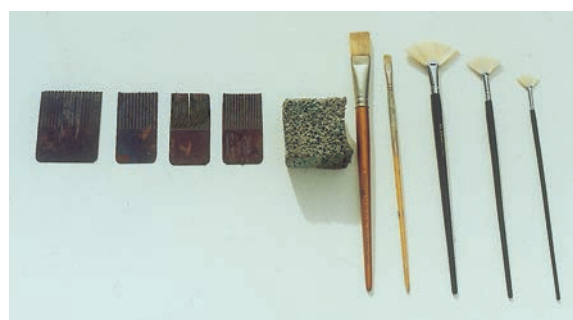
Det maleværktøj der sædvanligvis bliver brugt til ådring.
