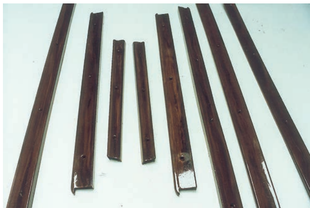
Listerne lakeres 3 gange med klar lak, vandslibes med nr. 1000 vandsandpapir og poleres med slibemasse og voks.
