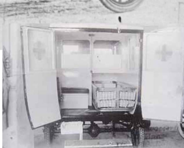
Ford T ambulance fra Røde Kors i Grenaa. Ambulancens interiør. Læg mærke til, at også denne ambulance er meget kort, hvorved der er lavet en udbygning i højre side af førerhuset.
