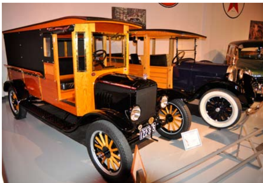
Ford TT Huckster 1926. Ford Model TT Truck er i den viste skikkelse meget lig de tidlige depot hack, som blev brugt til at transportere rejsende og bagage til og fra jernbanestationerne, en 'stationcar'. Fire cylindre på række, sideventilet og 20 heste.
