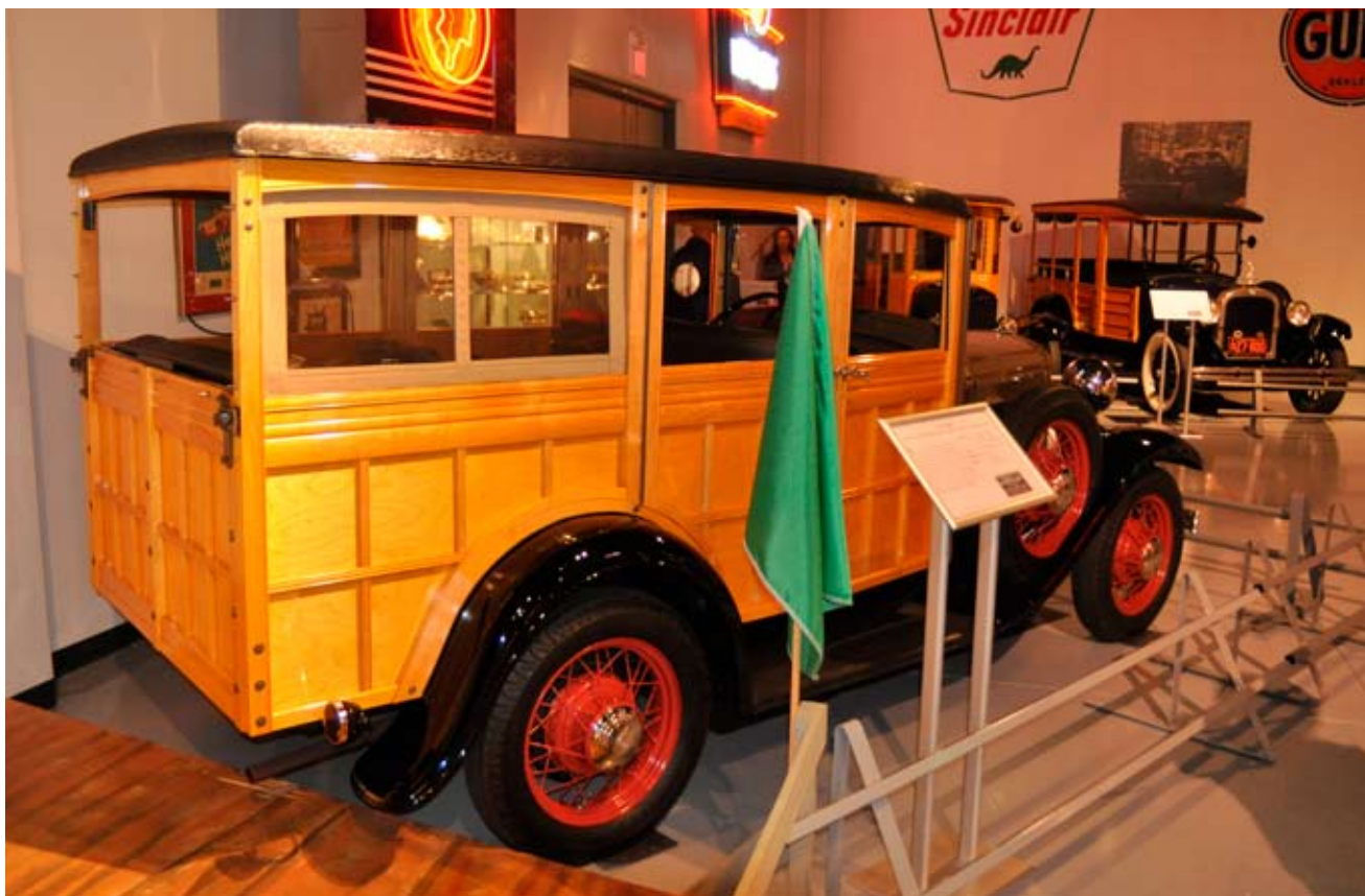
Ford Model A 150B Station Wagon 1930. Fra 1920 havde Ford en fabrik i byen Iron Mountain, Mississippi, hvor man fremstillede træelementer til T-modellen, men fra 1929 indeholdt A-modellen meget lidt træ, så man omlagde produktionen og blev underleverandør af trækomponenter til karrosserifabrikkerne Murray Body Co. i Detroit og Baker-Raulang Body i Cleveland. Bilen på billedet har karrosseri fra en af disse fabrikker. Stadig fire cylindre, men flere kubik og nu 40 hk.
