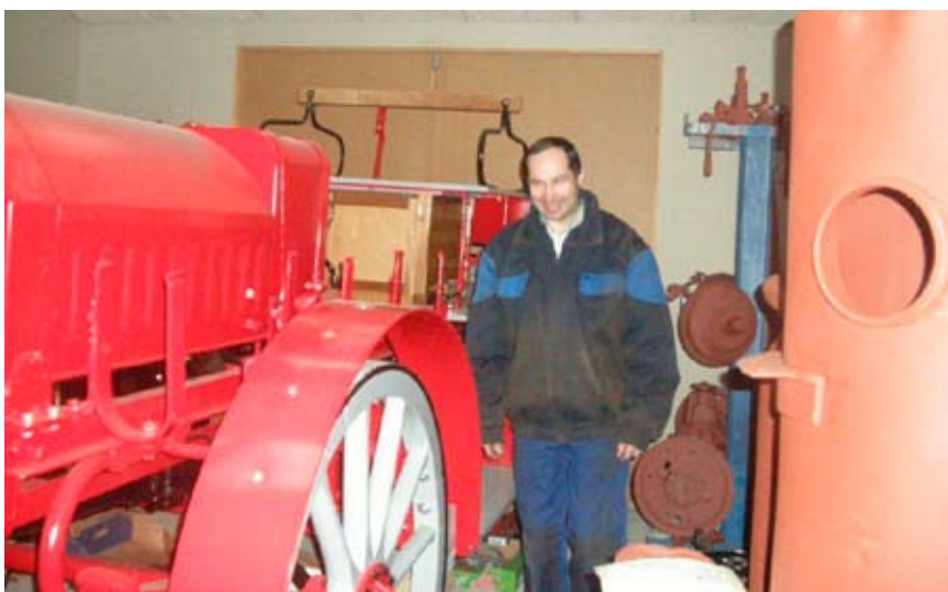
En hestetrukken brandsprøjte af tysk oprindelse er forsynet med en Presto motor til pumpen.
