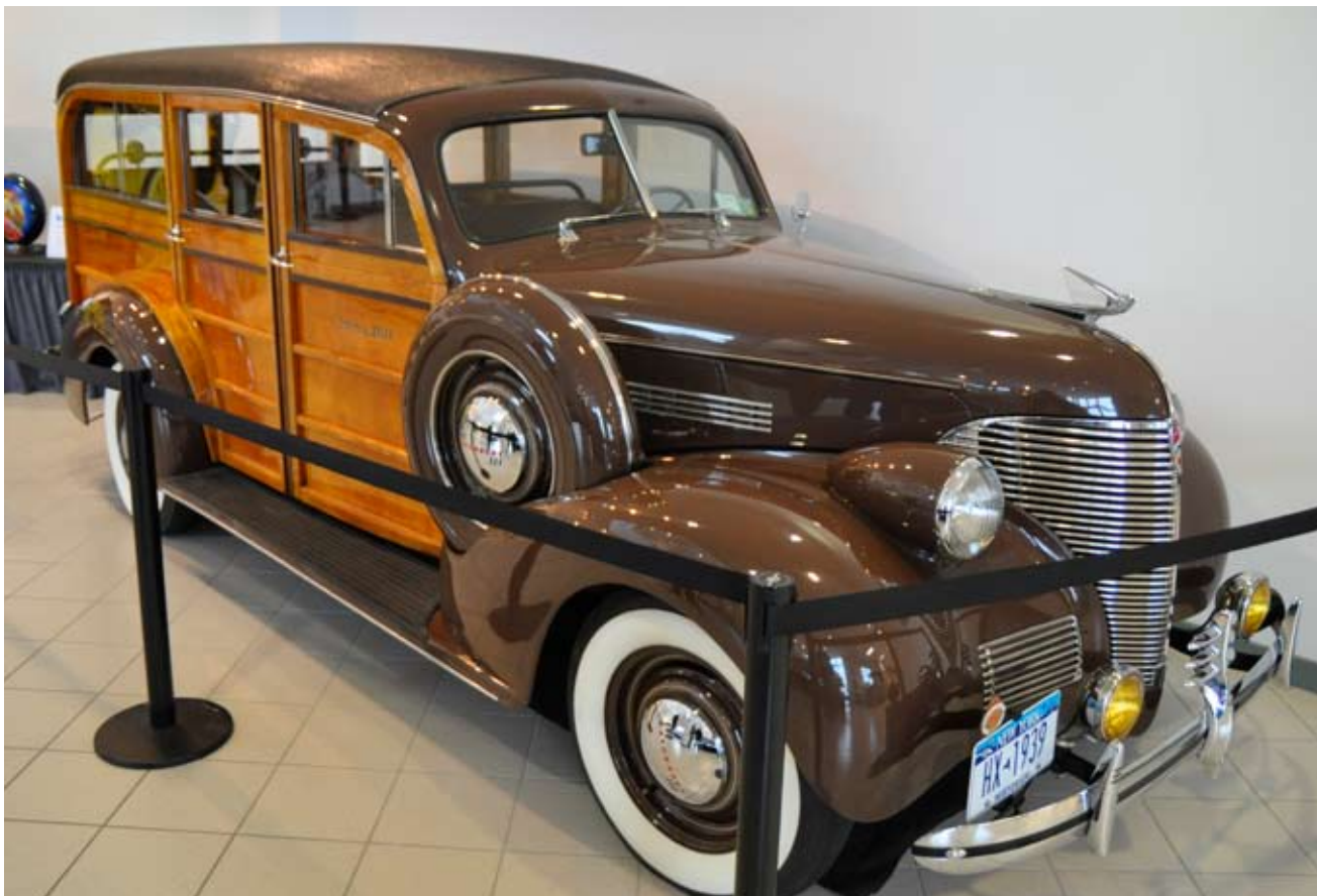
Chevrolet Master Deluxe Station Wagon 1939. Færdigbygget på Chevrolet's egen fabrik Mid-State Body Co. i staten New York. Seks cylindre i række, topventilet og 85 hk.
