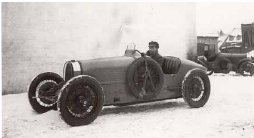
Type 37A raceren, som Bugatti-Kaj høstede en del succes med, var en kompressorladet udgave af den 4 cylindrede 1,5 liters type 37, som Bugatti i stort tal solgte til private købere. Dengang kørte man selv i bilen til banen, afmonterede i bedste fald lygter og skærme og var så klar til race.
