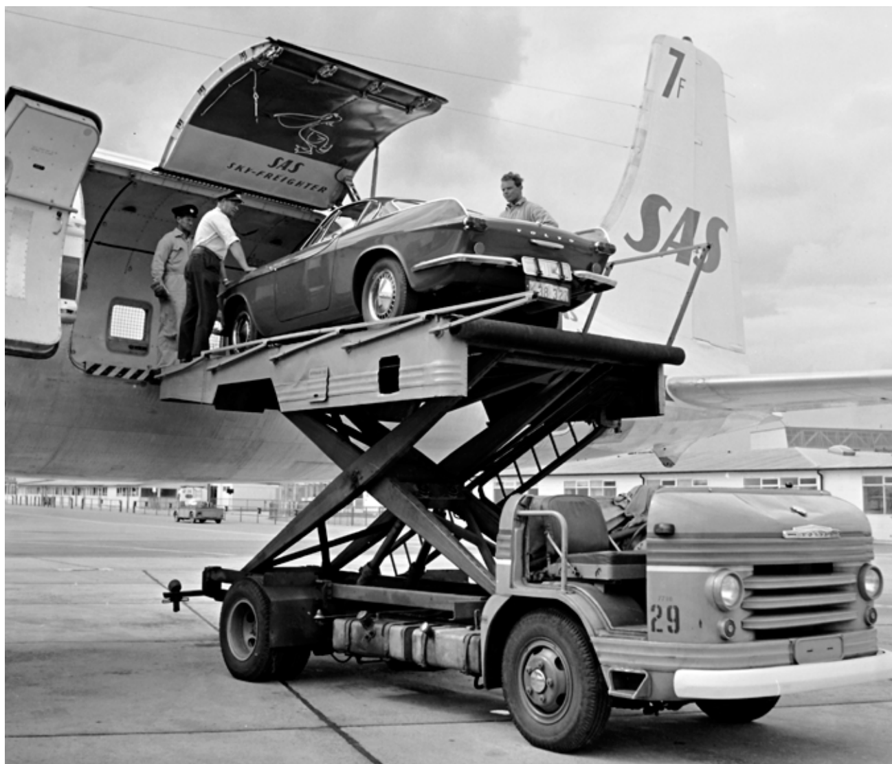
Den nye Erik Viking DC7F SE-CCI prøvelaster Volvo P1800 foran hangaren i Kastrup. Der er ingen pladsproblemer, dør og luge giver tilsammen en åbning på 3,14 m bredde og 1,98 m højde.
