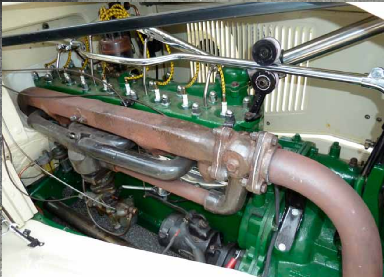
Den 4,9 liter Lycoming motor med 8-cylindre på række
