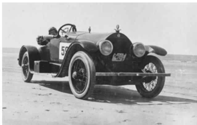
Helge Christensen i Stutz ved Fanøløbet 1920 Bemærk at kølerfiguren (Termometeret) og DMK-emblemet (bag motorhjælmen) er drejet en halv omgang, for at mindske luftmodstanden. Førersædet må også have været sænket, enten det, eller også har hr. Christensen været af udsædvanlig kort statur.
