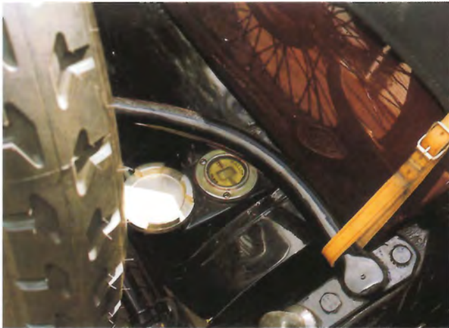
Udvendig benzinmåler direkte på tanken.
