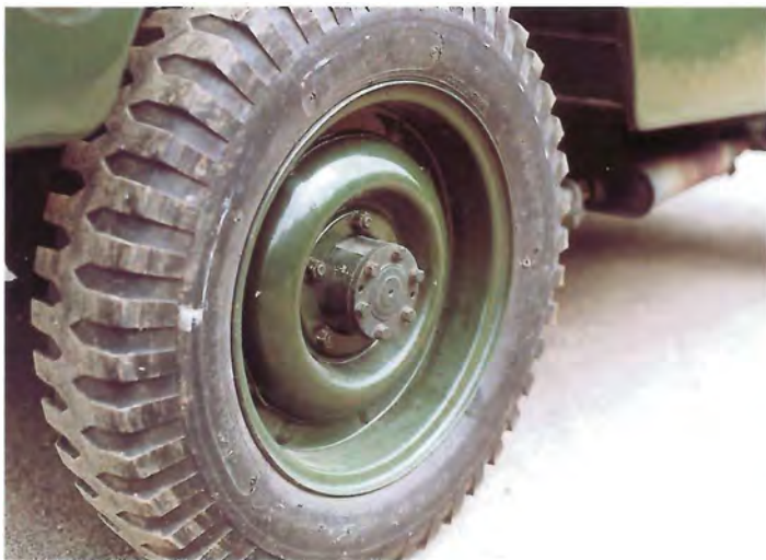
En helt typisk ting for krigsjeepen er de helflydende bagaksler. På billedet kan man også se de såkaldte combat rims, delefølge, som i høj grad letter en lapning ude i felten.
