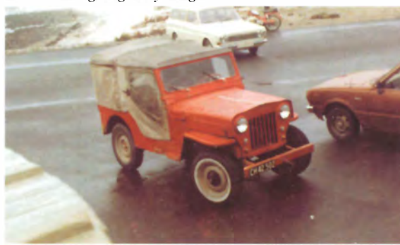
En CJ3B fra 1957. Bemærk den meget høje motorhjelme betinget af halvtoppermotoren. Der er udelte vindspejl i presset pladeramme, og kalechen er fredstidens mere komplicerede type, som kan fjernes halvt, så bilen bliver en meget kort pickup.
