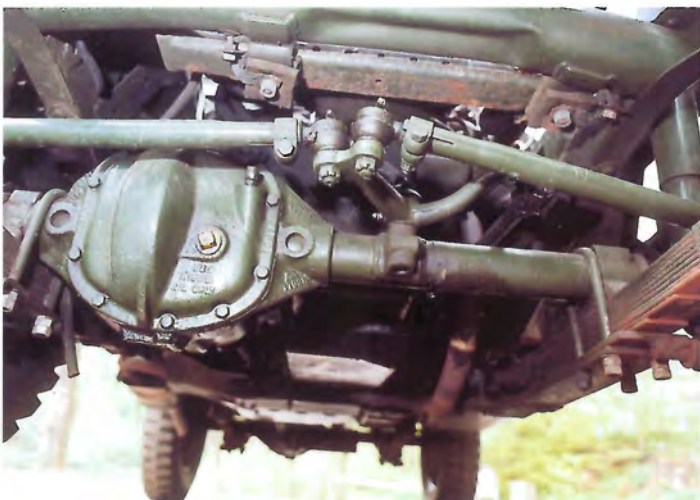
Typisk for krigsjeepen er styretøjets hjælpearms, som er anbragt på forakslen. På efterkrigsversionerne er armen flyttet op på den runde vange lige under køleren.
