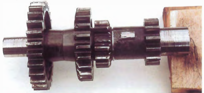
Tandhjulet er repareret og monteret på akslen, tandstumpen er placeret ved den opbyggede tand.
