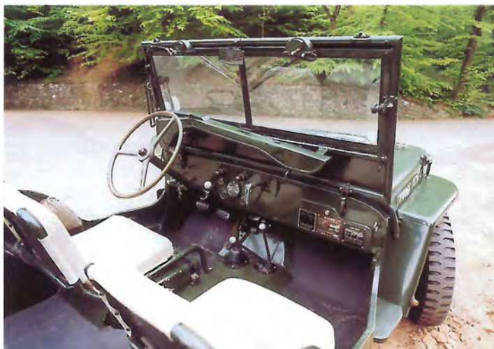
Fra førerpladsen kan man se holderen til Enfield-riflen. Så er der det klassiske militære instrumentpanel med milespeedometer omgivet af kølertemperaturmåler, olietrykviser, amperemeter og benzinur. Til hjælp for kørsel i terræn er der håndgasknap. De to knopper er instrumentlys, og paraplyhåndtaget er håndbremsen. I gulvet ses den konventionelle gearstang, ved siden af sidder greb for indkobling af firehjulstræk samt greb for høj/neutral/lav udveksling i mellemgearkassen.
