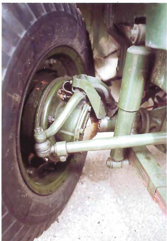
Typisk for krigsjeepen er styretøjets hjælpearms, som er anbragt på forakslen. På efterkrigsversionerne er armen flyttet op på den runde vange lige under køleren.
