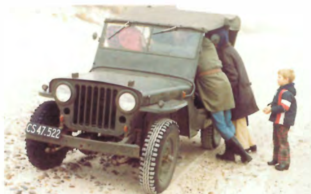
En tidlig CJ2A, som stadig har huller i frontpanelet til mørk-lægningslygter. Den har ratgear og påskruede sealbeamlygter.
