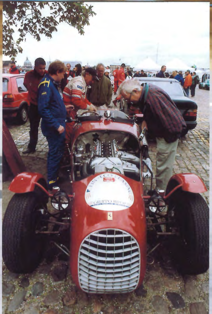
Kaj Bertelsens røde racer har Ferrari køleremblem, men det er mere indviklet end som så. Italieneren Clemente Biondetti (fire gange Mille Miglia vinder) byggede i 1950 en Jaguar Special, som han kørte under navnet Jaguar-Ferrari. Men den havde faktisk et rør-chassis fra Maserati. Motor, gearkasse, forløj og bremses var Jaguar XK120 og det hele var pakket ind i et Ferrari type 166 karrosseri.
