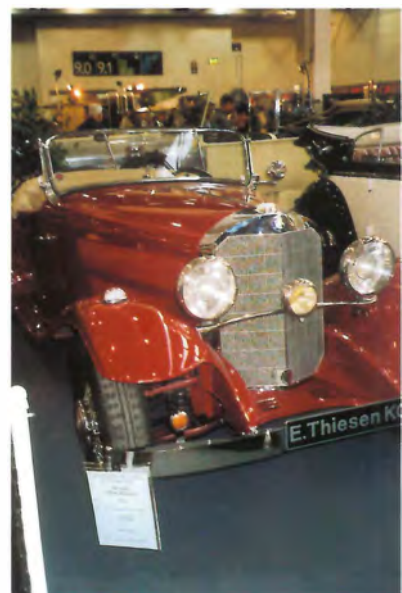
Mercedes-Benz 380K 1934 roadster. Nok så sjælden som de store 540K. I kompressorversionen ydede den 8-cylindrede motor på 3.8 liter 120 hk mod de normale 90.
