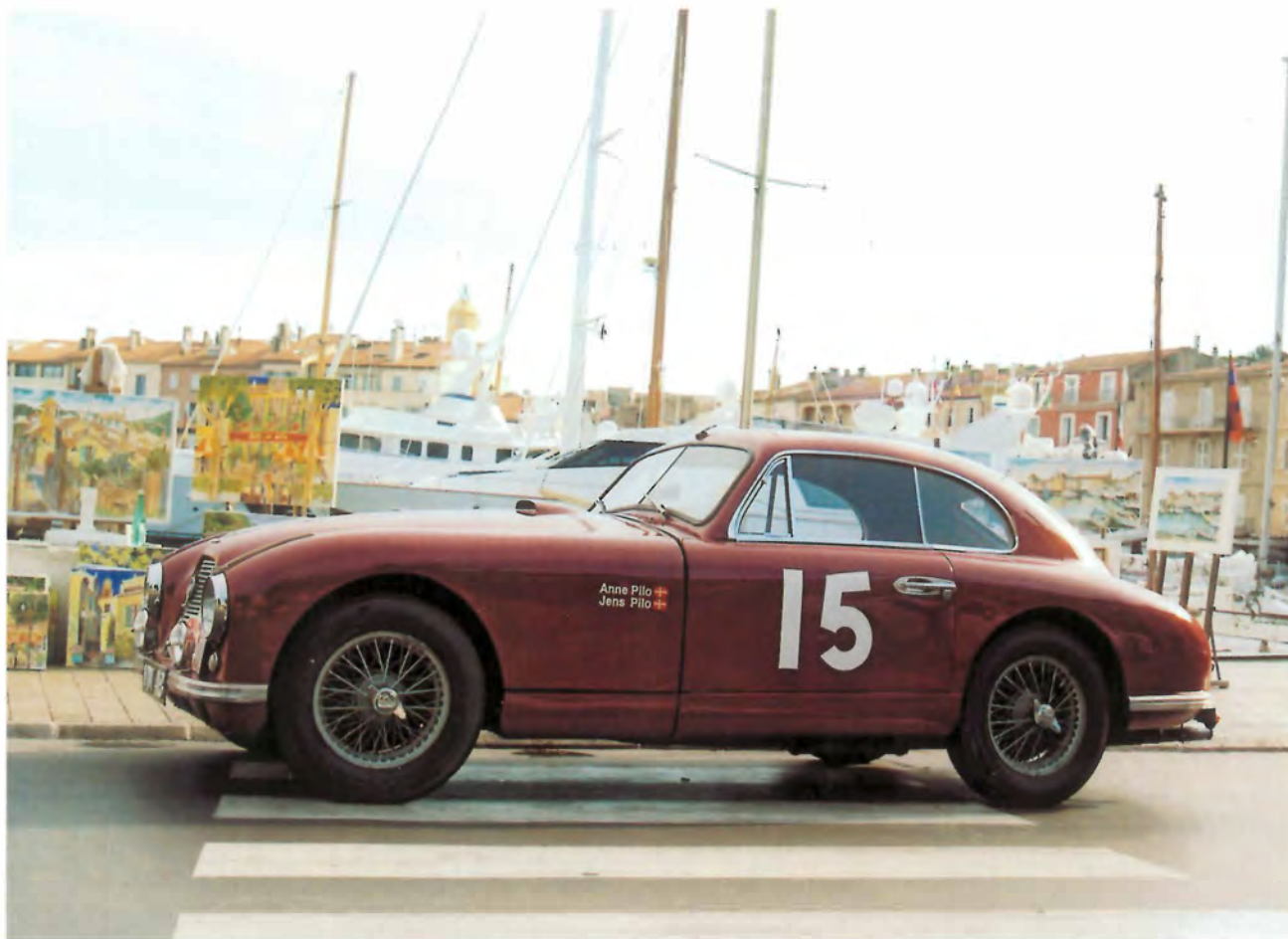
DB2 er udført med en gitterkonstruktion, derfor sidder dørene højt.
