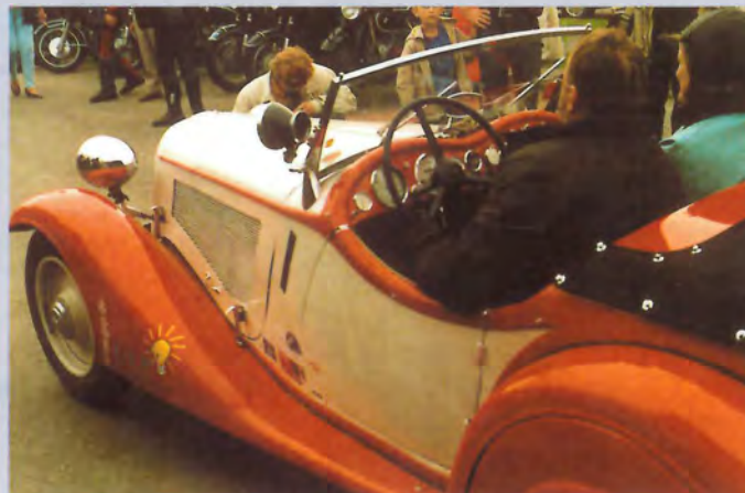
315/1, forløberen for type 328. 1.5 l, 6 cylindre, 3 karburatorer.
