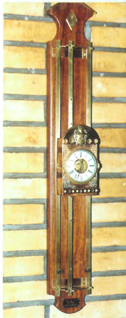
Den midterste stang er en tandstang (egen fabrikation forstås). Man trækker uret op ved simpelthen at trække det op. Så går det ved egen vægt langsomt nedad.
