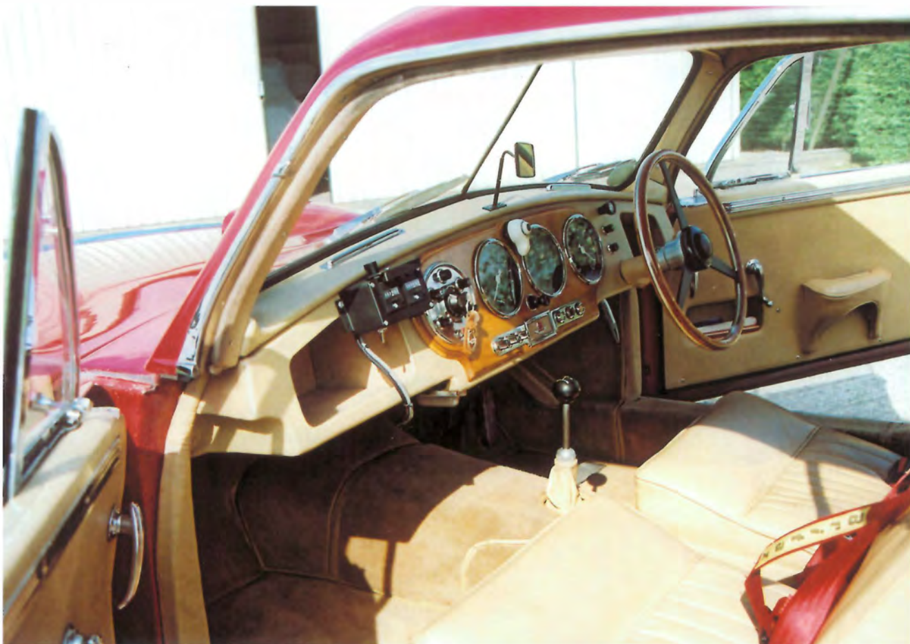
Den dobbelte triptæller kan ses i forgrunden og omdrejningsstøtteren sidder lige foran føreren, hvorimod speedometret er helt til venstre.
