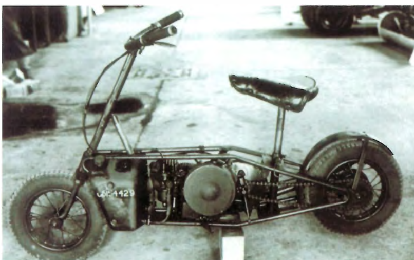
Dette er faldskærmsmotorcyklen WELBIKE, CORGIens forfader. Der er også dobbelt rørstel, og tanken er todelt og forsynet med en pumpe, så benzinen kan trykkes op til karburatoren.
