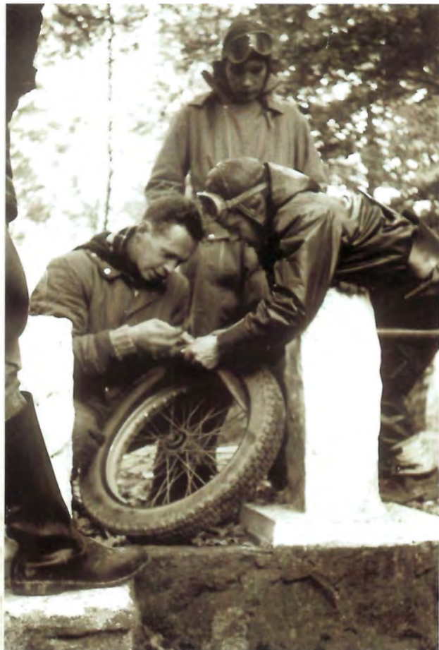
En kører med en BSA Golden Flash har en punktering, som selvfølgelig klares på stedet, for lappegrejer havde man jo med. Bemærk hjulet, som kunne afmonteres via stikaksel, uden at bremsetromlen fulgte med. Styrhjelmene er ikke almindelig endnu.
