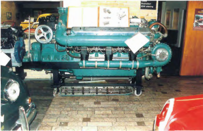
Isotta Fraschini motortorpedobådsmotor på 18 cylindre og et slagvolumen på 57 liter fra 1923. Den ydede 1500 hk. ved bare 2000 o/m.
