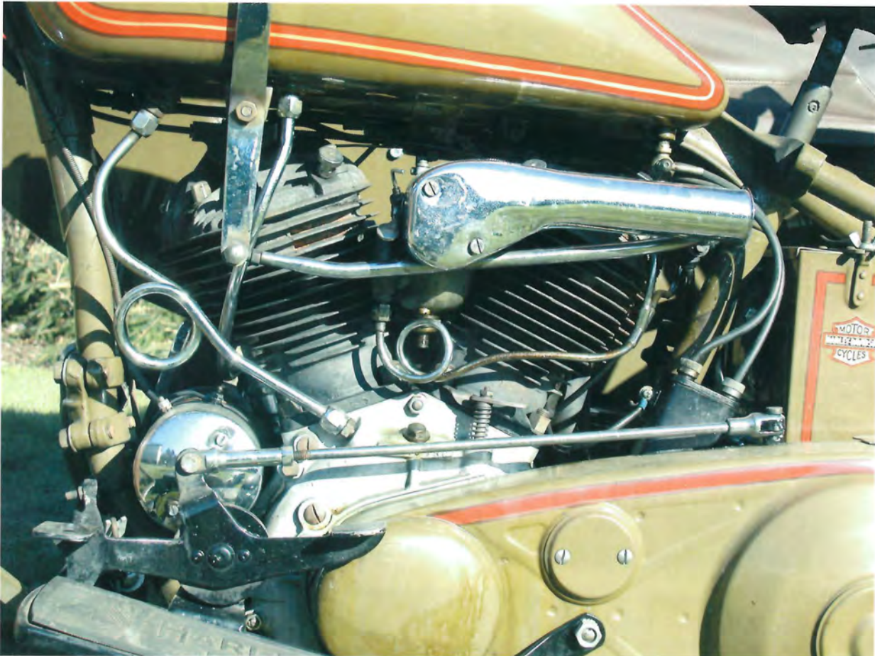
1200 cc 1931. På venstre side ses den fodbetjente koblingspedal. Vippes den bagover, kobler den ud.
