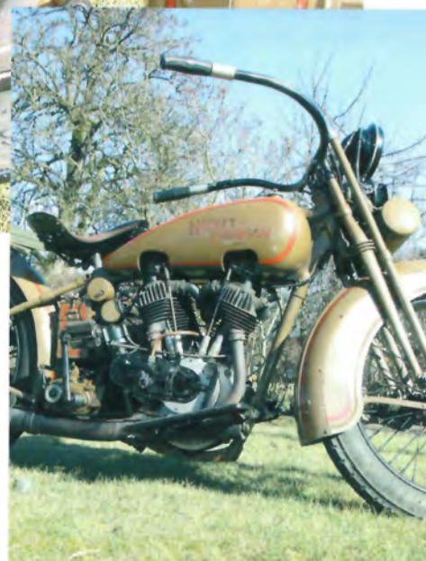
Fotoet demonstrerer det store Harley-styr med kun gasfunktion i højre håndtag og lyskontrol i venstre.
