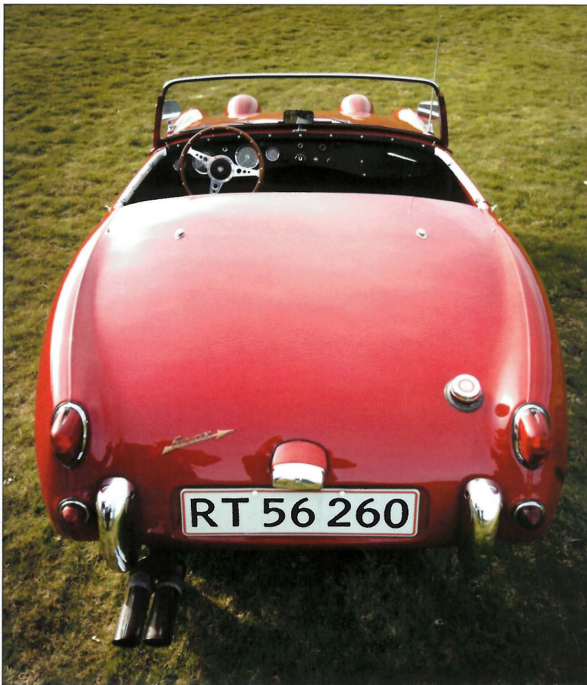
Det var ikke kun ansigtet på Spriten, der vakte opsigt. Også rumpetten gav anledning til undren: Hvor var klappen til bagagerummet? Den var der ikke, for af hensyn til karrosseriets stivhed var den uden klap. Bøge og reservehjul måtte graves frem fra dybet bag sæderne.
