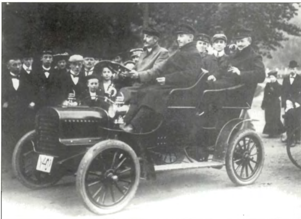
Den tidligste danske Ford, vi har fundet. Det bør være en model C fra 1904, og det ses af nummerpladen at den var indregistreret i Vejle amt. 2-cylindret boksermotor.
