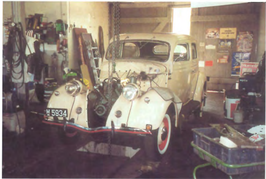
Fabriksny motor bliver monteret i sommeren 1999. Den har nu kørt ca. 25.000 km uden problemer.
