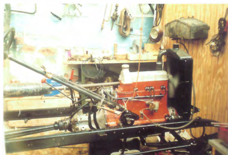
Motor; gearkasse m.v. klar til afprøvning.
