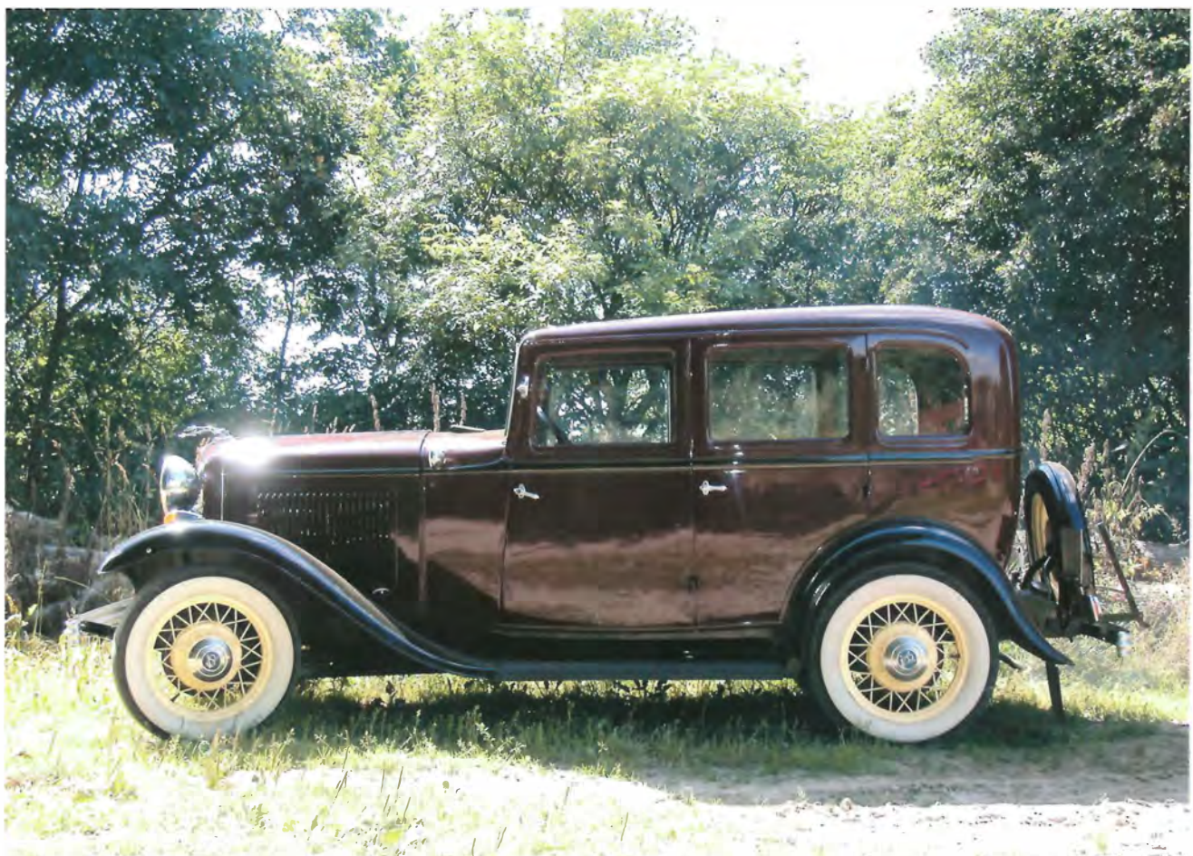
Bemærk at begge døre er baghængslede. På en Ford A Fordor er fordøren fronthængslet, og når man hos 32'eren har valgt at baghængsle, må det skyldes, at den tilbagelænedes stil ikke tillader en fronthængsling.
