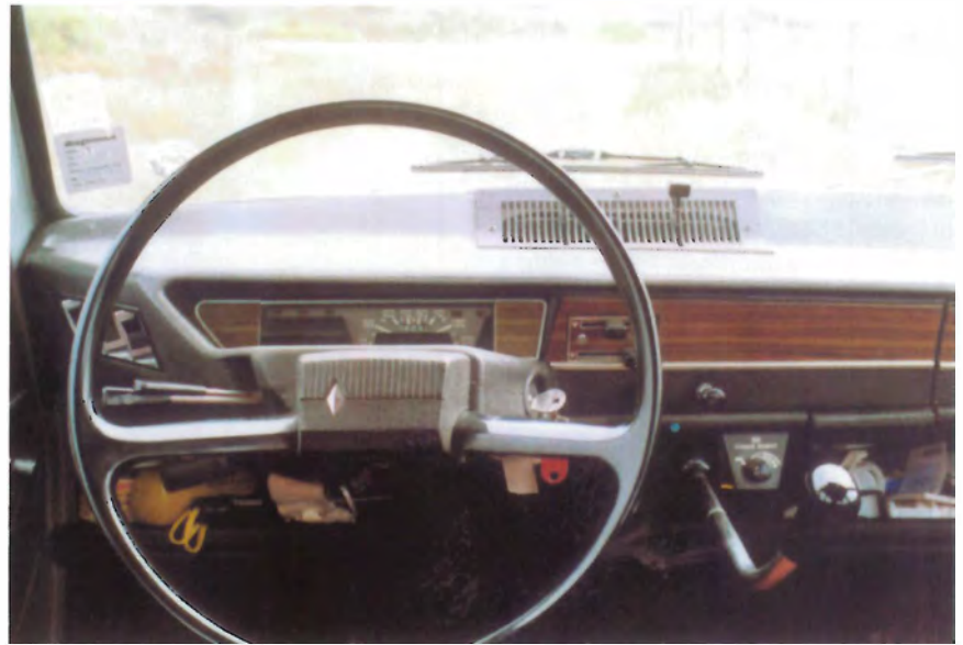
Bag rattet i Renault 6L. Her ses tydeligt gearstangen af paraplytypen.
