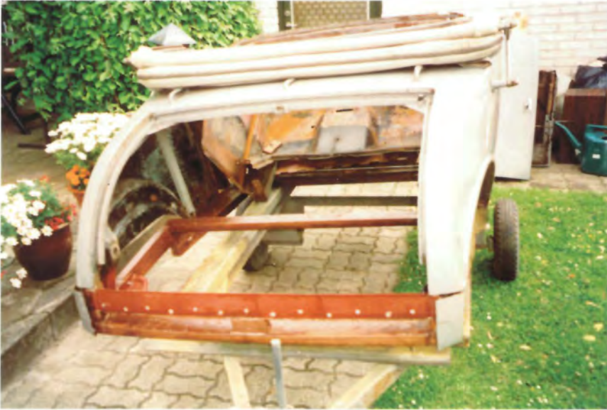
Nyt træværk mange steder. Læg mærke til afbukning af plade helt agter.
