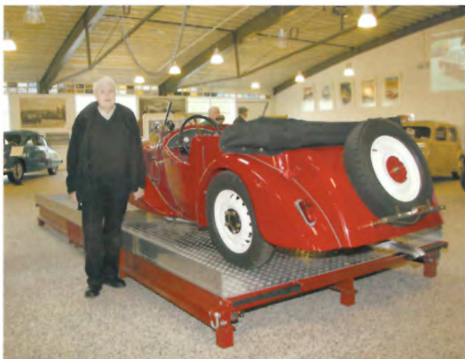
John Møhls Aero 30 1935 har platformchassis med uafhængig affjedring hele vejen rundt. 2-cylindret, vandkølet totaktsmotor på 998 cc og forhjulstræk. 30 hk, 100 km/t.
