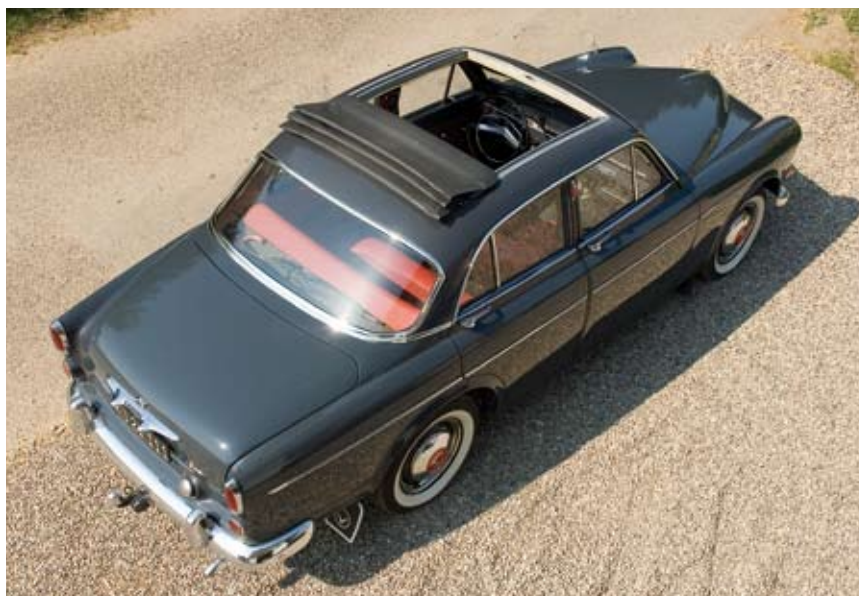
122S 1962. B18D motor med dobbelt SU-karburatorer på 100 SAE hk. Her i en udgave med en del ekstraudstyr, bla. Golde foldetag, overdrive gearkasse og differentialebremse på bagakslen.
