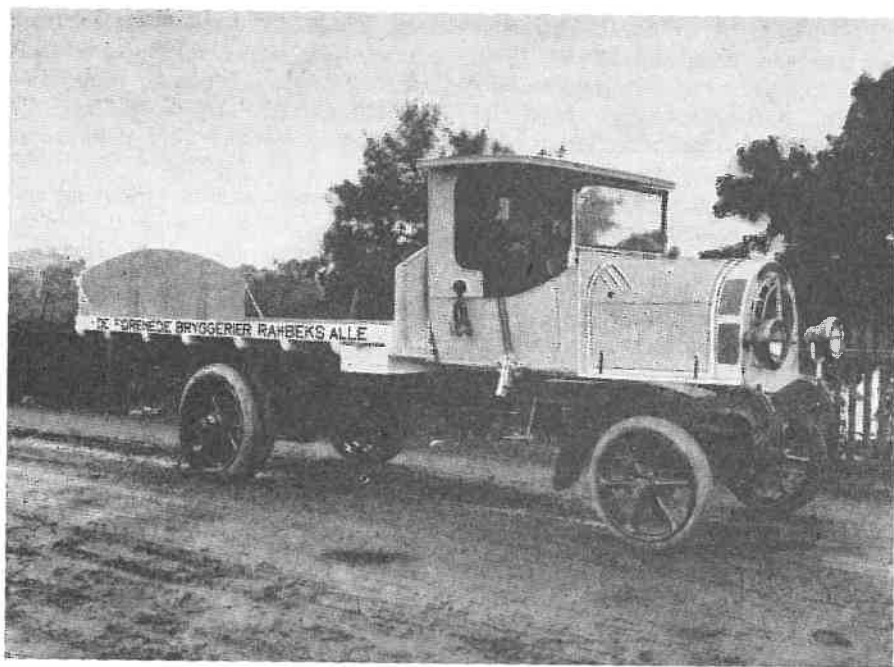
To modstykker fra Thriges mangesidige produktionsprogram. Ovenfor ses en »Thrige«-lastbil fra 1915, 50 hk, med 5 tons lasteevne. En 5 t lastvogn blev på den tid betragtet som kolossal. Vognens store frihøjde blev i dette tilfælde udnyttet til ophængning af øltønder i kæder under ladet. Den karakteristiske kølerfront skyldes anvendelsen af en centrifugalventilator og en speciel køler placeret uden om denne. - På siden til højre: En elegant, lukket »Thrige«-model - fra den tid, da lukkede biler endnu var sjældne.
