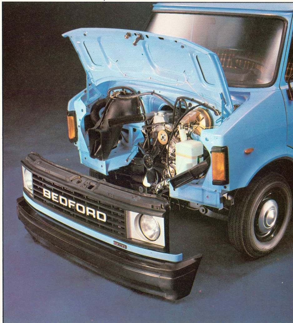
Hele fronten kan afmonteres ved at fjerne otte bolte.
