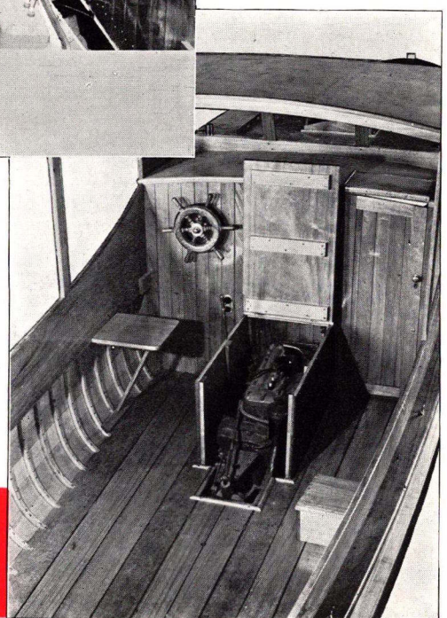
Styrerummet og Motorerne, over hvilke Laaget er fjernet.
