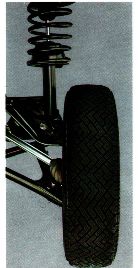
En fremragende fjederkomfort, som en følge af de højt anbragte skruefjedre. Forhjulstræk, der gør bilen ufølsom over for sidevind, bratte sving og glat føre.
