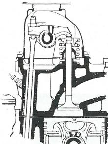
Ekstra store topventiler – med separate indgangsåbninger. Symmetrisk forbændingskammer. Det giver blødere og mere lydløs kørsel og flere kilometer på hver benzinpåfyldning.
