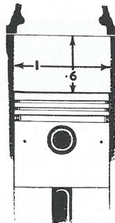
Den nye, overkvadratiske 41 hk motor giver top-ydelse med lavere benzinforbrug og mindre motorslitage. (Forholdet mellem slaglængde og boring er 0.6:1).
