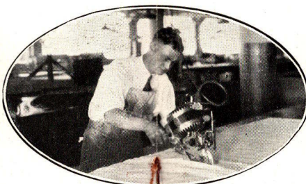
Ved Hjælp af denne Skæremaskine skæres indtil 1000 Lag af Betræk til paa een Gang
