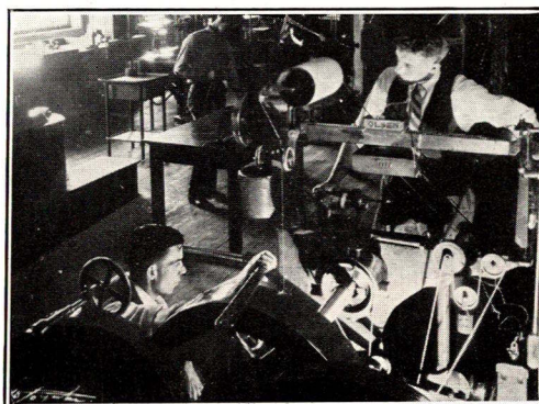
En af de utallige andre Prøver paa Laboratorierne. Akslens Modstandsdygtighed overfor Vridning bedømmes.
