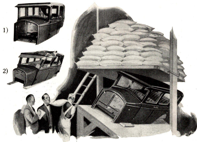
En Belastningsprøve, under hvilken Karosseriet udsættes for Tryk paa 4500 kg. De to smaa Billeder viser: 1) Fisher Karosseriet af Træ og Staal, som det saa ud efter Prøven og 2) et andet Karosseri, af Staal alene, efter Prøven
