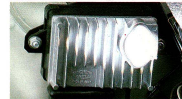
Det elektroniske Digiplex tændings-system sørger for at tændingen sker i det rette øjeblik.
