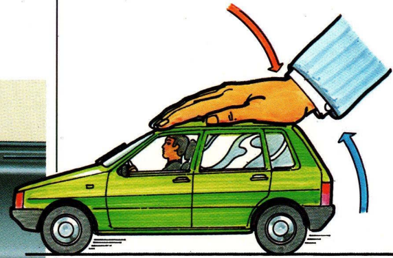
Affjedringssystemets udformning med anti-roll modvirker bilens naturlige tendens til at dykke med næsen under opbremsninger.
