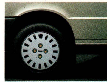
De strømliniede hjulkapsler og spoilerne foran baghjulene nedsætter luftmodstanden og gør bilen endnu mere benzinøkonomisk.
