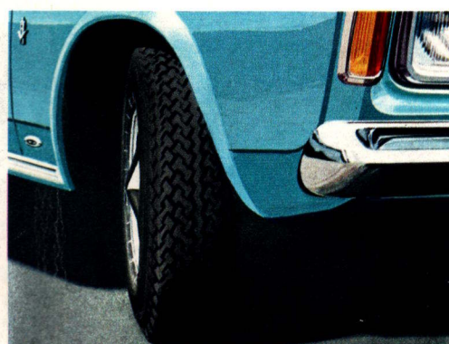
Slangeløse radialdæk med ekstra brede slidbaner.
