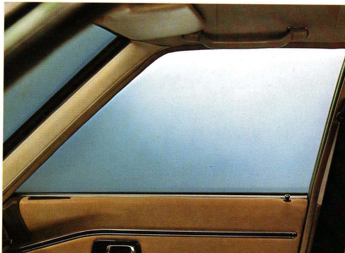
Vor dem Einschalten der Defroster-Düse: Auf der Fensterscheibe bildet sich oft ein Beschlag, der die Sicht behindert.
