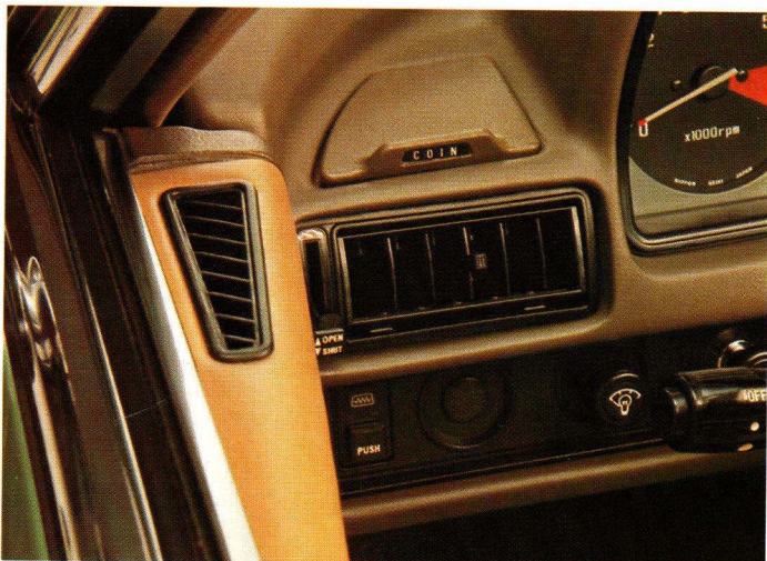
Das ausgeklügelte Heizungs-/Lüftungssystem bedient auch zwei Defroster-Düsen für die vorderen Seitenfenster.
