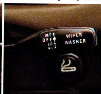
Die Wisch-/Waschanlage; vom Steuerrad aus leicht zu bedienen.
