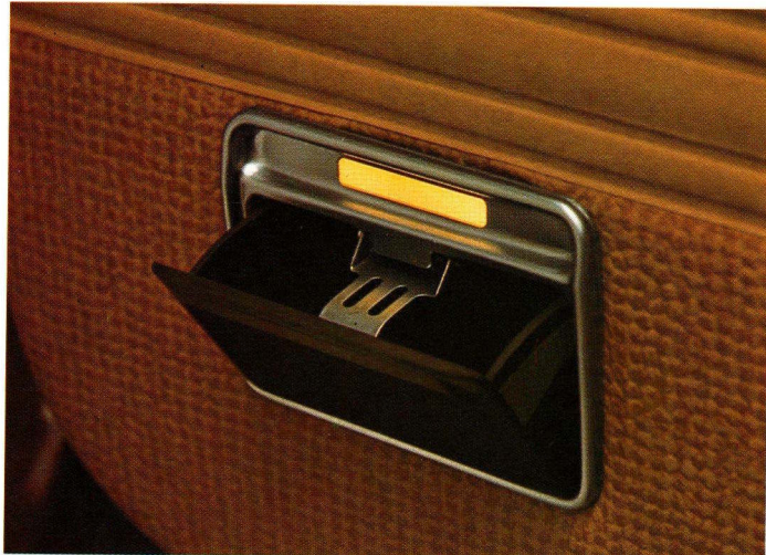
Drei Aschenbecher mit Beleuchtung für die Mitfahrer sind in die Türen eingebaut.
