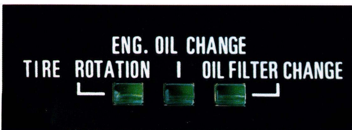
3. Serviceindikatoren angiver ved farveskift, hvorledes det står til med vedligeholdelsen.
