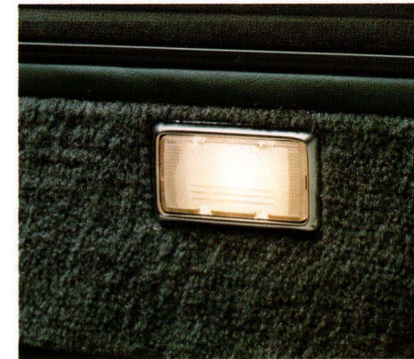
Når døren åbnes, sørger et lys i dørsiden for, at De kan se hvor De sætter fødderne, når De i mørke skal ind og ud af bilen.
