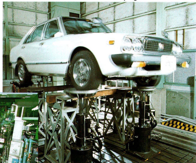
Accorden testes for dens evne til at optage vibrationer.
