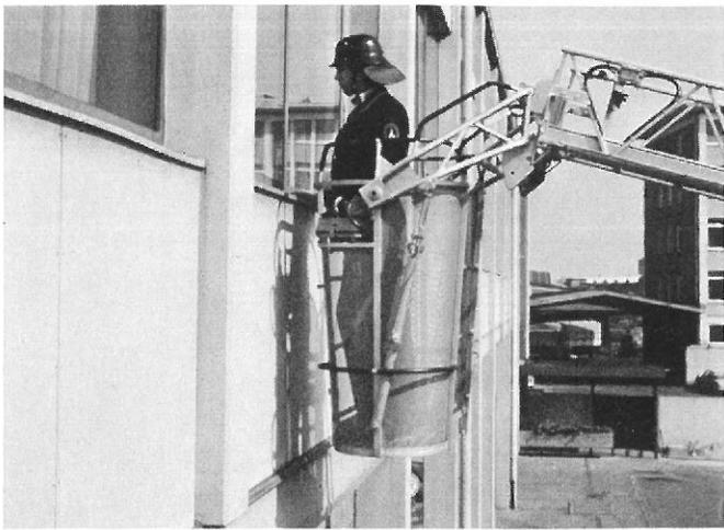
Sichere und wertvolle Hilfe bei vielen Einsätzen: der Magirus-Rettungskorb. Mit zwei Mann belastbar. Er wird an der Leiterspitze mit tiefer Schwerpunktlage so eingehängt, daß er bei jedem Aufrichtwinkel automatisch in der Senkrechten gehalten wird. Ein doppelt beaufschlagter Dämpfungszylinder bewirkt ein kontrolliertes Pendeln des Korbes beim Leiterbetrieb. Ein kleiner Handhebel stoppt die Pendelbewegung des Korbes.
