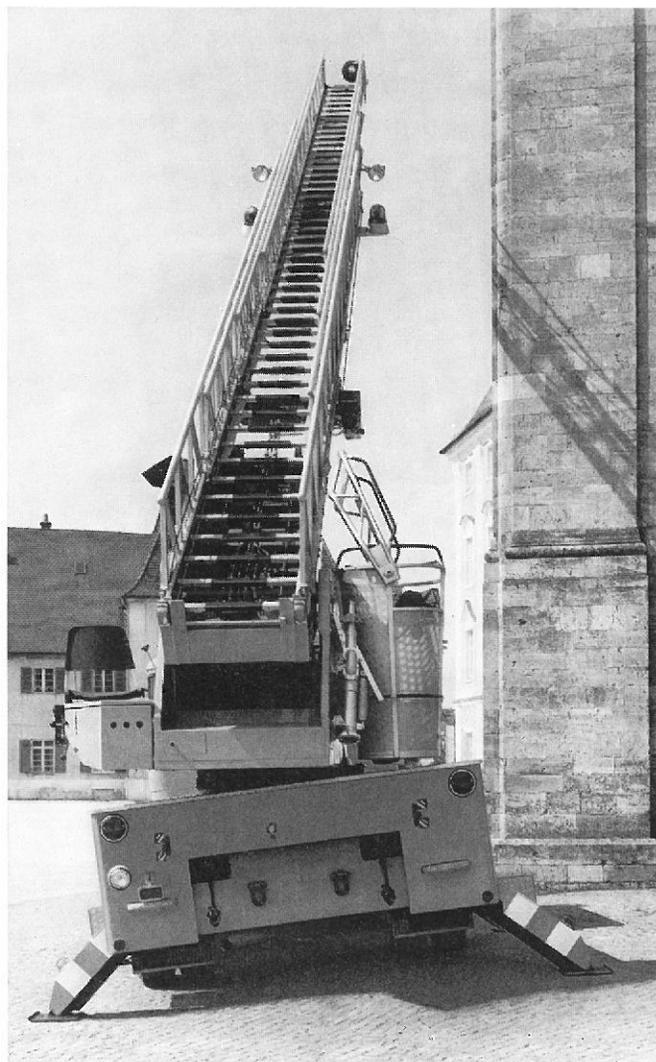
so daß auch Leitereinsätze an tieferliegenden Punkten möglich sind. Der neue **Geländeausgleich**, bei dem die volle Ausregulierung des Leitersatzes durch kardanisch arbeitendes Getriebe bei allen Aufrichtwinkeln von  $-15^\circ$  bis  $+75^\circ$  erfolgt.
