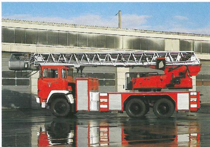
Dieses leistungsfähige Rettungsfahrzeug ist immer noch wendig. Selbst mit der fest an der Leiterspitze angebrachten Bühne bleibt sie unter 3,30 m Höhe! Weil die LB 30/5 noch nicht einmal 10 m lang ist, kann sie auch enge Kurven problemlos durchfahren.
