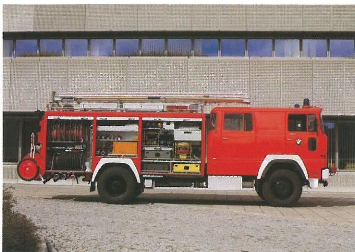
Der eingebaute 20 kVA Generator stellt genügend Strom zur Verfügung, um über die Flutlichtscheinwerfer am ausfahrbaren Lichtmast die Einsatzstelle auszuleuchten. Hilfeleistungs-Ausrüstung. Zusätzlich können damit genügend elektrische Arbeitsgeräte angetrieben werden. Starke Seilwinde. Motorleistung 171 kW (232 PS)!
