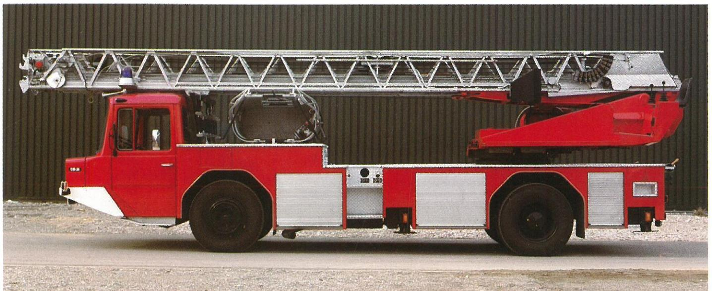
Das Vario-Drehkranz-System mit dem Seitenausgleich, der gleich zu Beginn der Leitermanöver die Leiter so ausreguliert, daß sie sich später immer auf einem horizontal liegenden Drehkranz dreht und nicht mehr nachregulieren muß.
