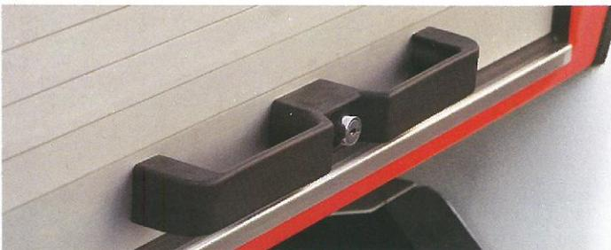
Die Betätigung des Schubladen-Verschlusses erfolgt durch den neuen Doppelhandgriff. Dieser Doppelhandgriff hat mehr Freiraum zum Greifen, auch mit Handschuhen. Wie Sie sehen, haben Rolläden und Schubladen dieselben Doppelhandgriffe und dasselbe Verschlusssystem.
