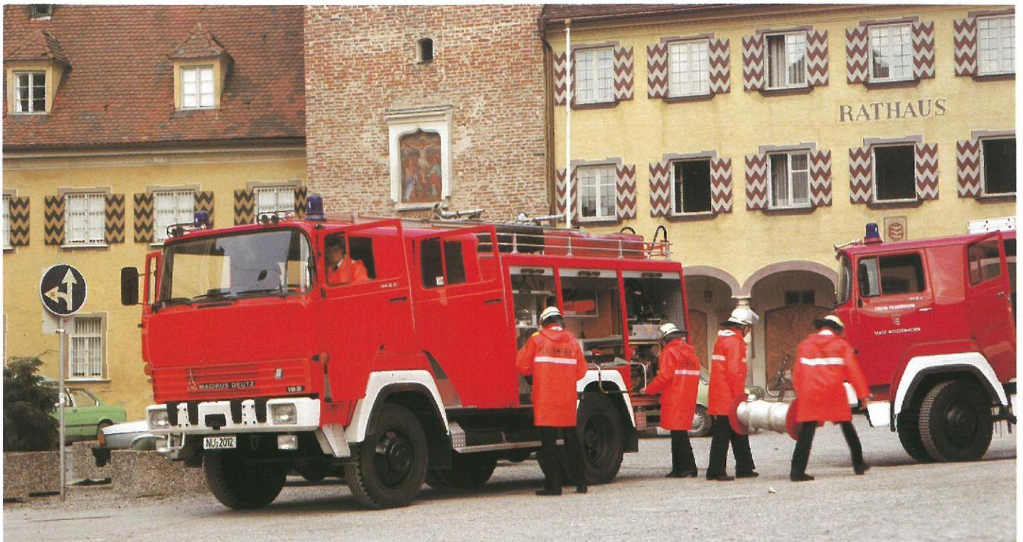
**Tanklösch-Fahrzeuge nach DIN 14 502 und 14 530: MAGIRUS TLF 8/18 1500 l und 2700 l. Die schnellen Wasserträger!**
