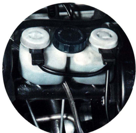
Unterdruckgesteuerter Bremskraftverstärker mit je einem Flüssigkeitsbehälter für jeden Bremskreis
