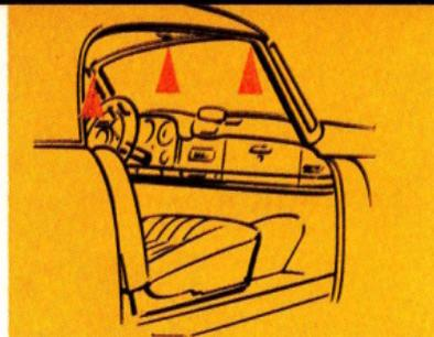
7 Verschlüsse halten das Leichtmetalldach sicher auf der Karosserie. Nach Lösen der Knebelgriffe und der Verschraubung ist das Coupédach abzunehmen. So wird aus dem allseits geschlossenen Coupé mit wenigen Handgriffen ein eleganter Roadster.
