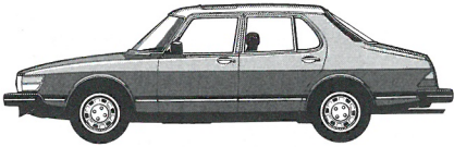
Saab 900 GLs, 4 døre. 2-karburatormotor, 79 kW (108 hk) DIN, 5-trins manuel eller automatisk gearkasse.
