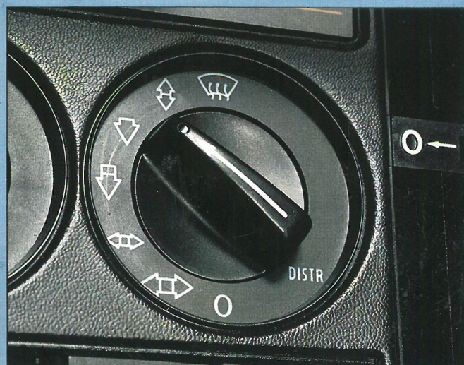
Betjeningsgrebet til luftfordeling har forpro-grammeret indstilling. Syv forskellige trin i nøje udtænkt rækkefølge. Hurtig indstilling uden irriterende finjustering. Vakuumbstyrede spjæld og klapper giver støjfri funktion.
