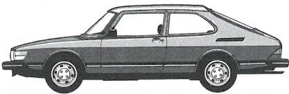
Saab 900 GL, 3 døre. 1-karburatormotor, 73 kW (100 hk) DIN, 4-trins manuel gearkasse.
