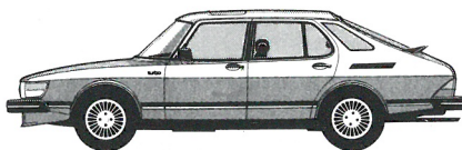
Saab 900 Turbo, 5 døre. Indsprøjtningmotor og turbolader, 107 kW (145 hk) DIN, 5-trins manuel eller automatisk gearkasse.
