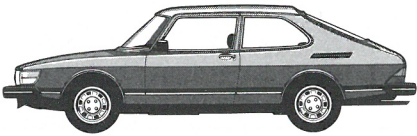
Saab 900 GLs, 3 døre. 2-karburatormotor, 79 kW (108 hk) DIN, automatisk gearkasse.
