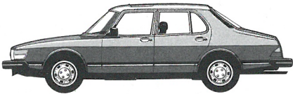
Saab 900 GL, 4 døre. 1-karburatormotor, 73 kW (100 hk) DIN, 4-trins manuel gearkasse.
