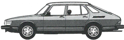
Saab 900 GLs, 5 døre. 2-karburatormotor, 79 kW (108 hk) DIN, 5-trins manuel eller automatisk gearkasse.
