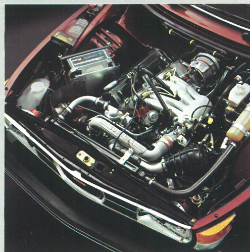
4-cylindrig, 2-liters turbo-laddad insprutningsmotor. Max. effekt DIN: 107 kW (145 hk) vid 5000 r/min.
