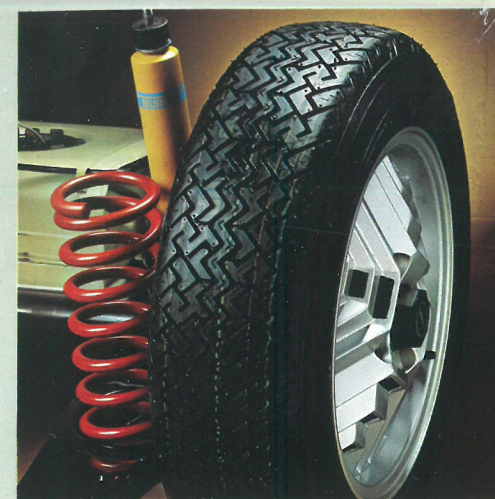
Bakfjädrar kombinerade med Bilstein gastryckstötdämpare. Pivot-lagrade fjädrar fram.
