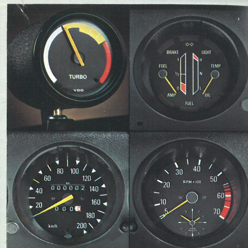
Fullständig instrumentering med bl. a. varvräknare och tryckmätare för turbo-aggregatet.
