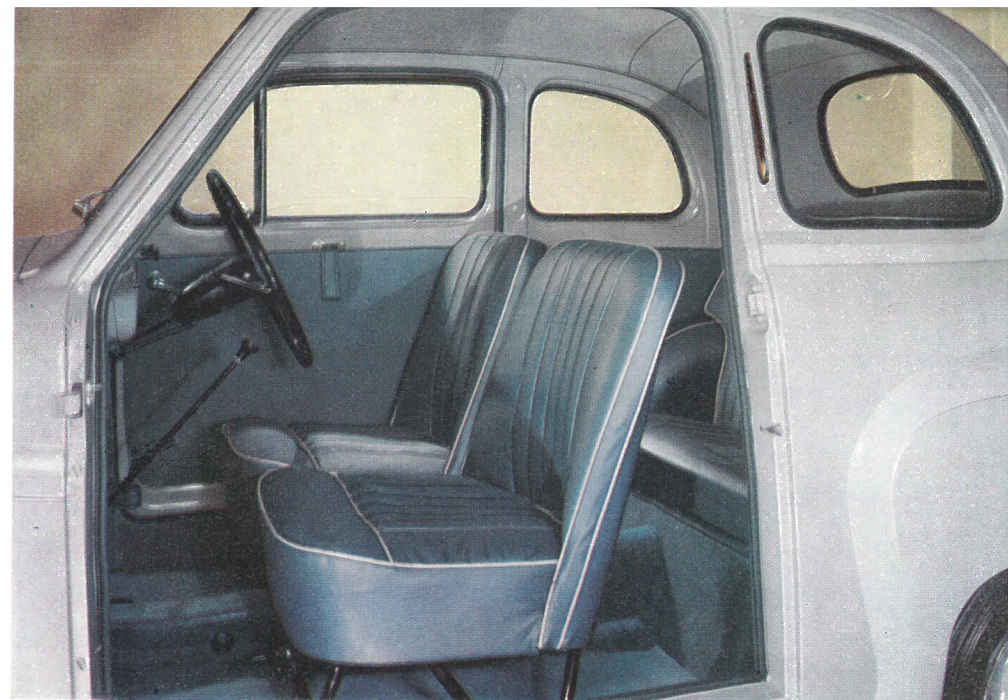
De to Enkeltstole foran giver en yderst behagelig Kørestilling for saavel Fører som Passager og kan paa et Øjeblik indstilles til enhver af de tre Stillinger. Sæderne er forsynet med Skumgummi.
