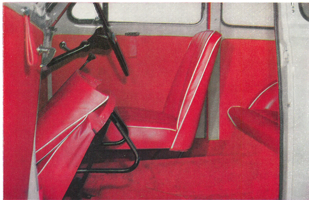
Bagsædet i 7'eren er ligeledes forsynet med Skumgummi og giver Plads til to Passagerer. Naar Forsædets Ryglæn slaas frem, og hele Sædet vippes, er der fin Adgang til Bagsædet. Dørfyldningerne er betrukket med samme Stof som Stolene.
