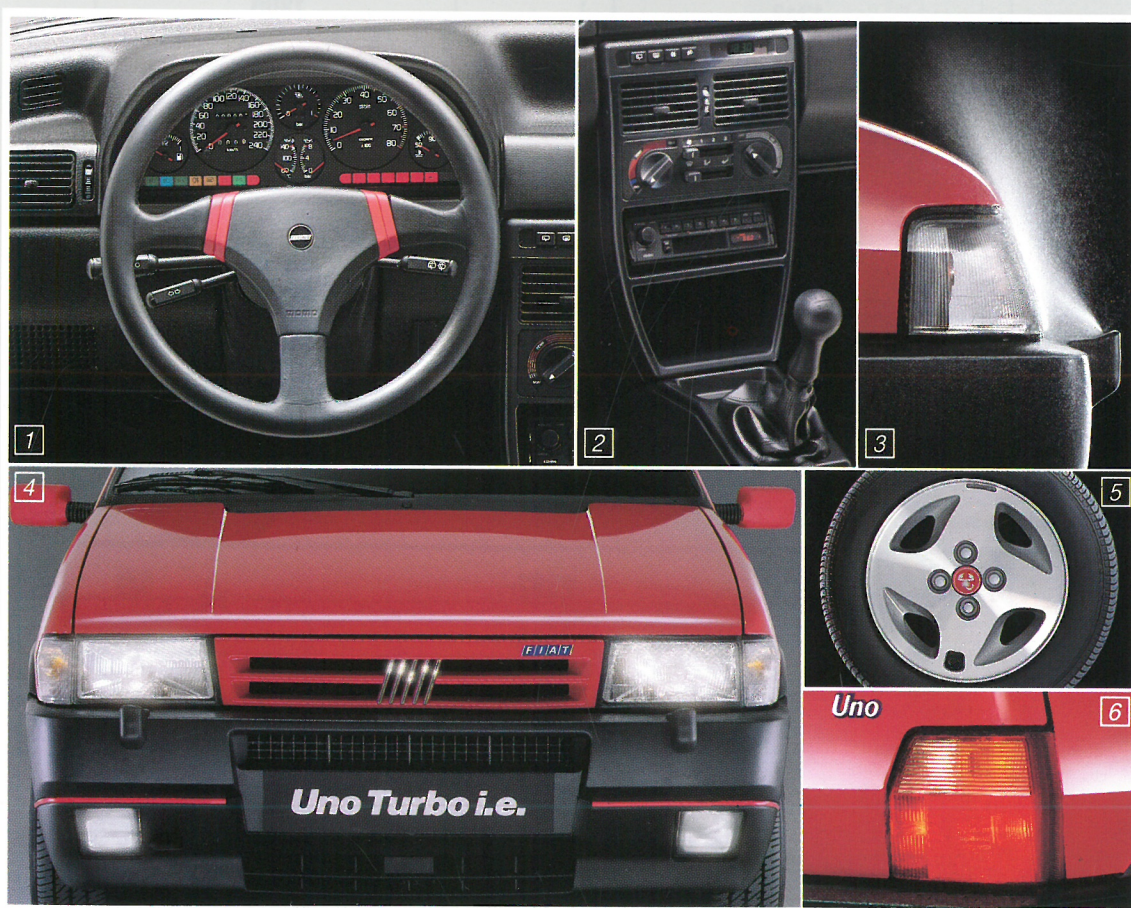
4. Kofanger med rød "turbo-stripe" og luftindtag. Tågelygter er indbygget i spolieren.
