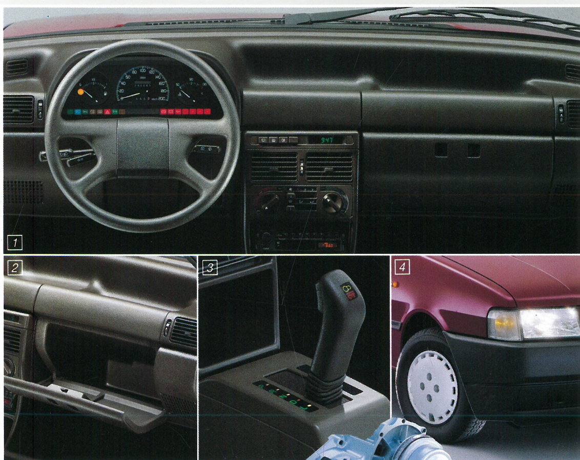
3. CVT gearstangen har 5 positioner. Nøjagtig som det almindelige automatgear.
