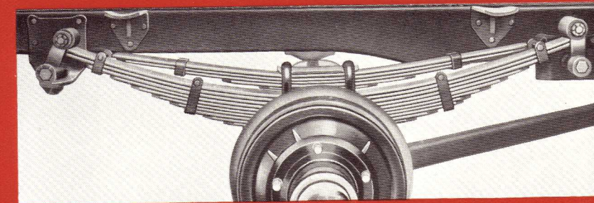
Lange Bagfjedre med Hjælpefjedre. To kraftige halveliptiske Bagfjedre - med paamonterede Hjælpefjedre - er i begge Enden ophængt i Fjederboljer med bronze-førrede Staalbæsnings. De to Bagfjedre bærer saaledes Vognens Vægt paa 4 Steder. Ved haard Belastning fordeles Vægten ved Hjælpefjedrene paa yderligere 4 Punkter.
