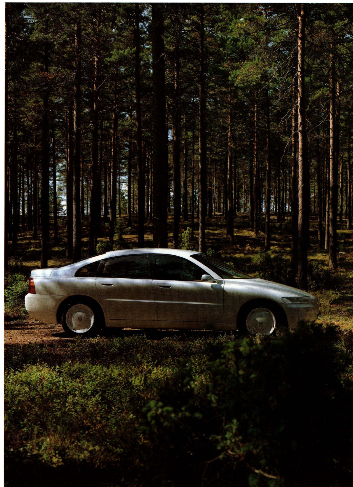
Volvo ECC - Volvo Environmental Concept Car - er en hybrid-elektrisk miljøbil. Den har el-motor, der drives af batterier, som igen oplades af en gasturbinegenerator. Når vognen ikke er i brug, kan batterierne også oplades via lysnettet. I bytrafik kan den køre på elektricitet alene, og på længere ture kan den køre ved hjælp af gasturbinen, der samtidig oplader batterierne og derved udvikler større motorkraft. Ved normal kørsel vil ECC belaste miljøet med en effekt, der kun svarer til ca. 50% af effekten forårsaget af en »almindelig« bil.
