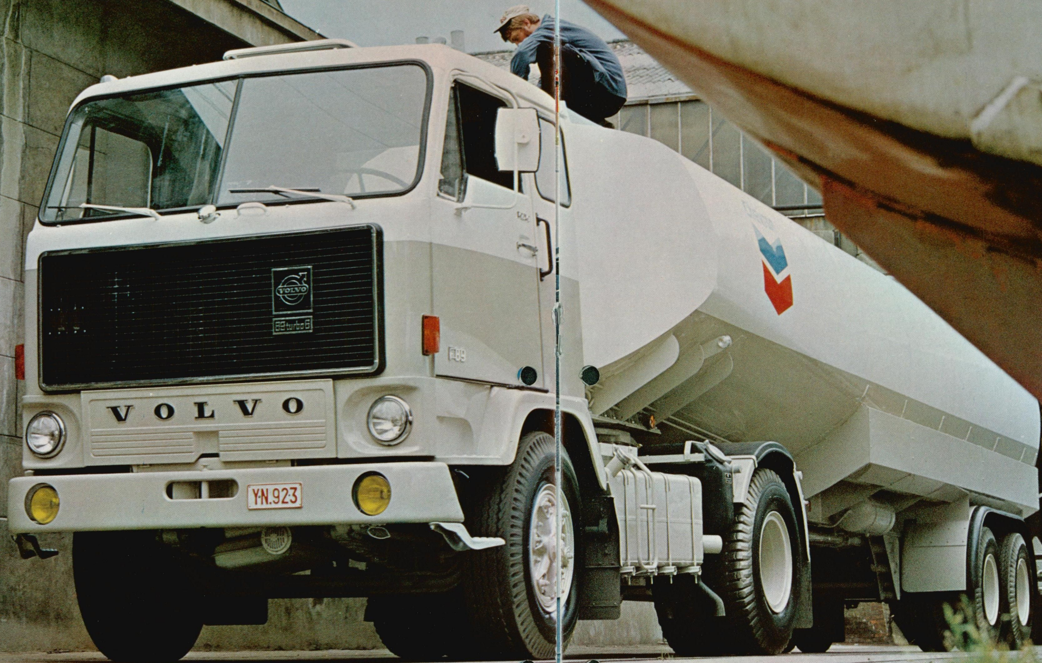
F 89 4×2 med 2-akslet tanksættevogn til transport af petroleum (Belgien).
