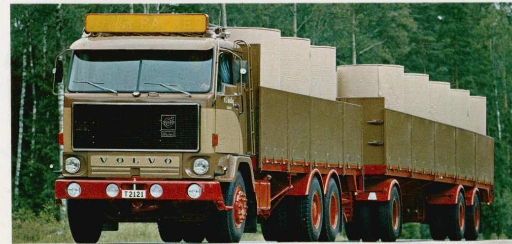
F 89-46 6x2 med 3-akslet påhængsvogn til transport af papir. TD 120, SR 61, navreduktion. (Sverige).
