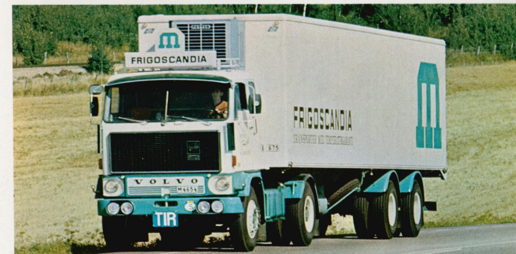
G 89-35 4x2 som forvogn for kølesættevogn. TD 120, SR 61, navreduktion.
