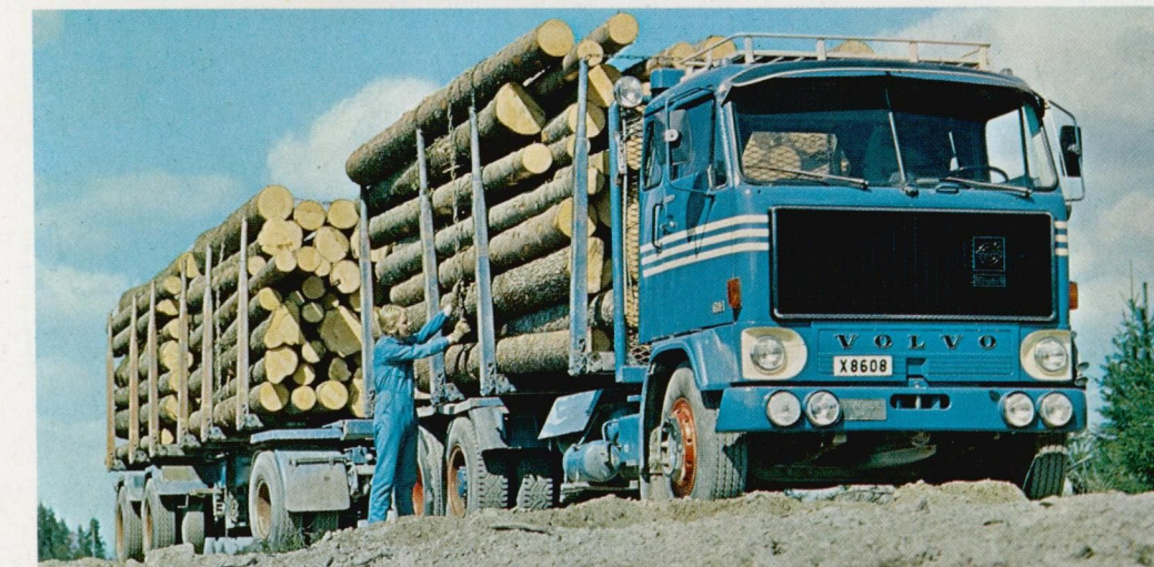
G 89-45 6x2 med 3-akslet påhængsvogn til tømmertransport. TD 120, SR 61, navreduktion. (Sverige).
