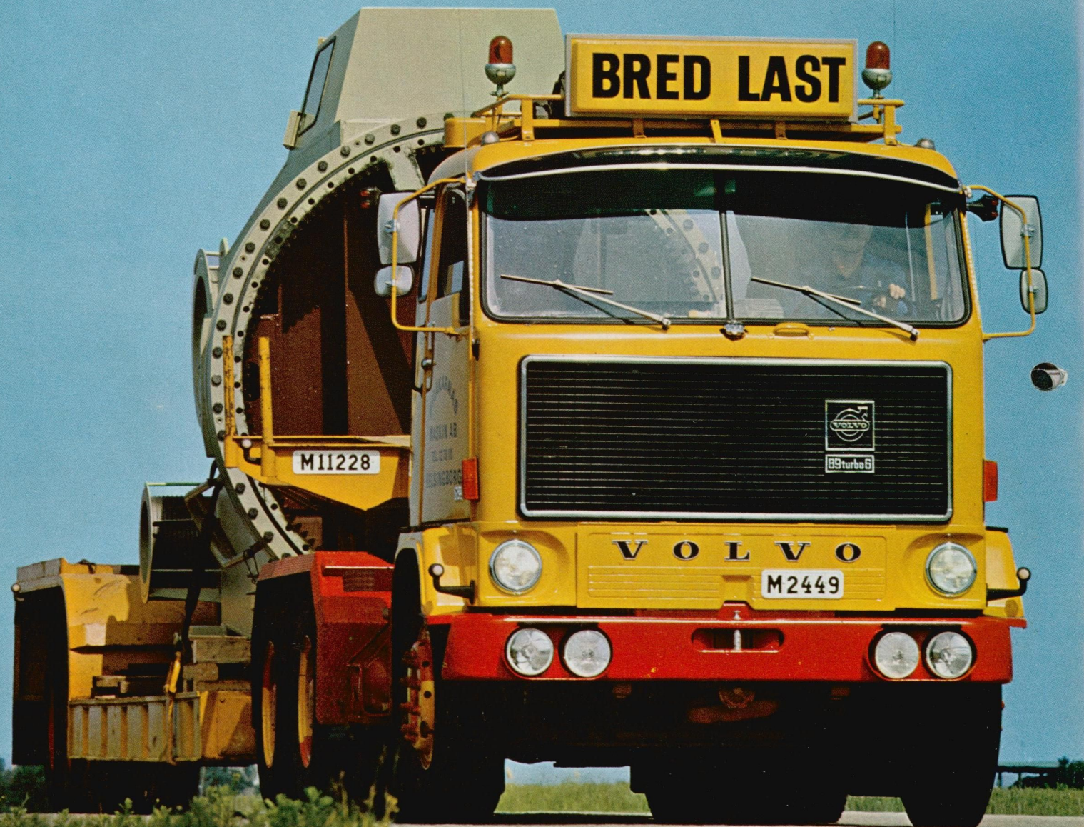
F 89 6x2 som forvogn for sættevogn til transport af maskingods (Sverige).
